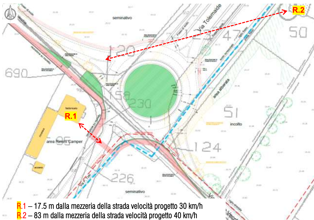
Fig. 3.2.a – estratto di progetto con indicati i due ricettori esistenti su tracciato futuro e le possibili velocità medie dei veicoli in transito
