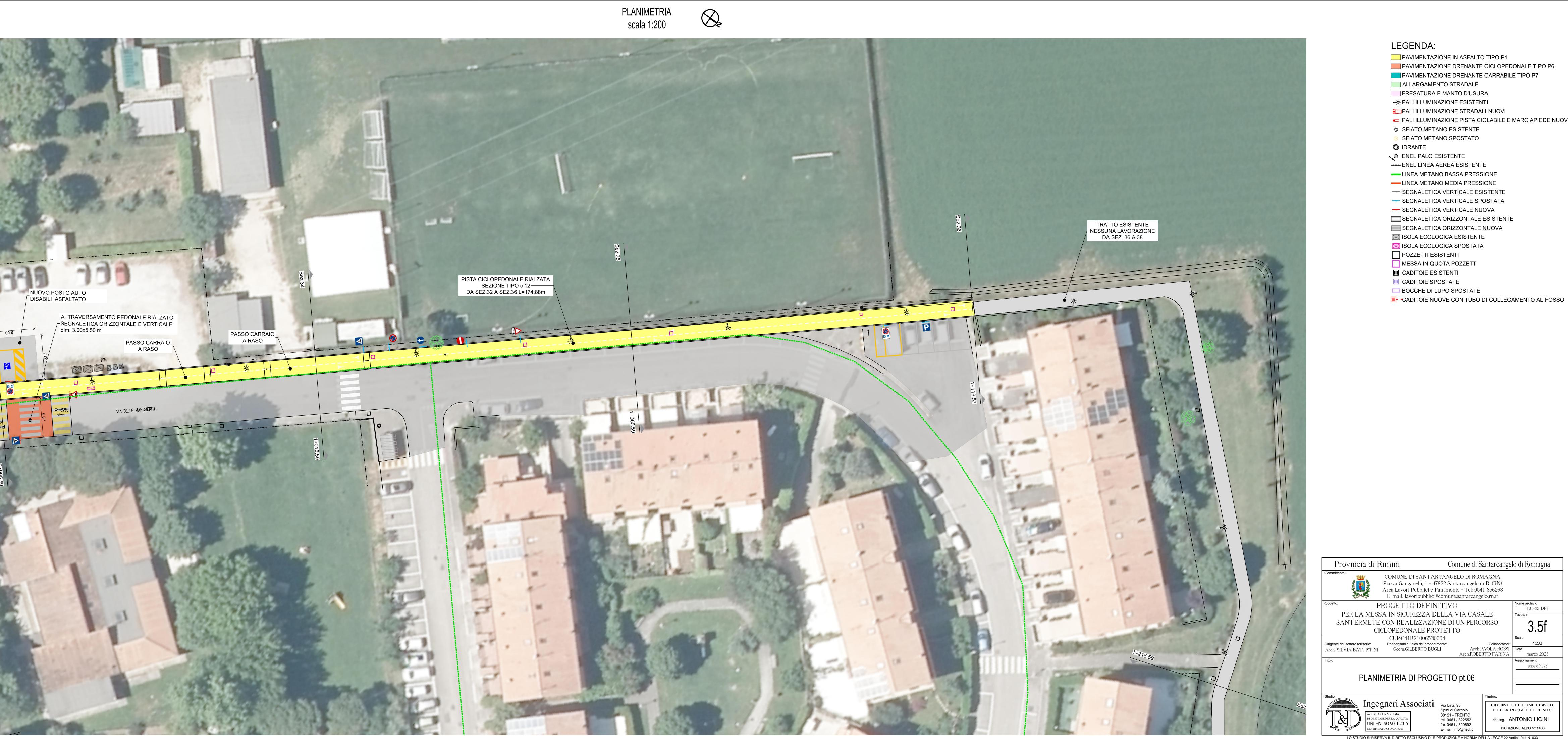
LEGENDA: PAVIMENTAZIONE IN ASFALTO TIPO P1 PAVIMENTAZIONE DRENANTE CICLOPEDONALE TIPO P6 PAVIMENTAZIONE DRENANTE CARRABILE TIPO P7 ALLARGAMENTO STRADALE FRESATURA E MANTO D'USURA ☆
