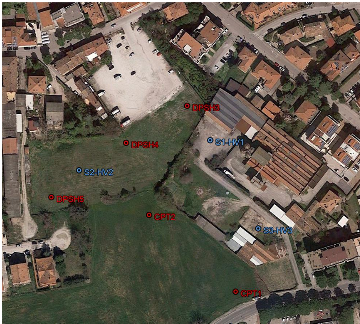
Fig. 6 – foto aerea con ubicazione delle indagini eseguite; S sondaggi a carotaggio, HV prove hvrs, Cpt prove penetrometriche statiche, Dpsh prove penetrometriche dinamiche.
