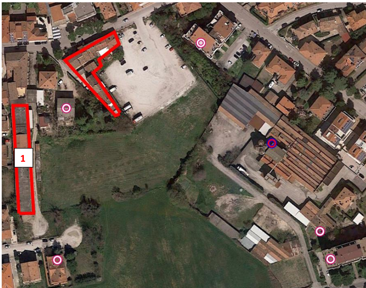
Fig. 37 – mappa dei potenziali ricettori prossimi al sito di intervento e per i quali si ritiene opportuno prevedere mitigazioni, controlli e precauzioni in fase di cantiere (1. Edifici in corso di realizzazione).
