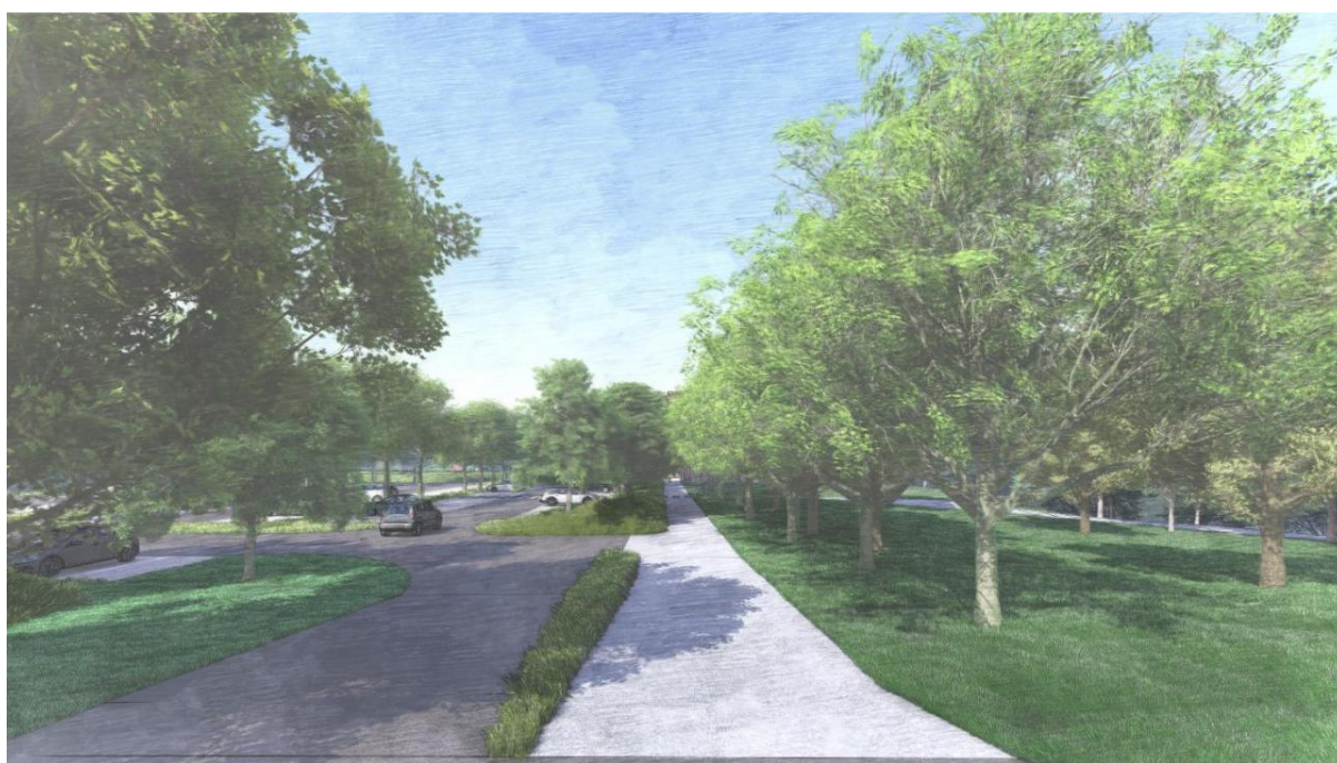
Fig. 31-32: Viste del buon rapporto superficie pavimentata permeabile e vegetazione. In questo modo si vuole contribuire a mitigare la presenza delle auto nel sito e a ridurre l'aumento della temperatura nel parcheggio durante l'estate.
