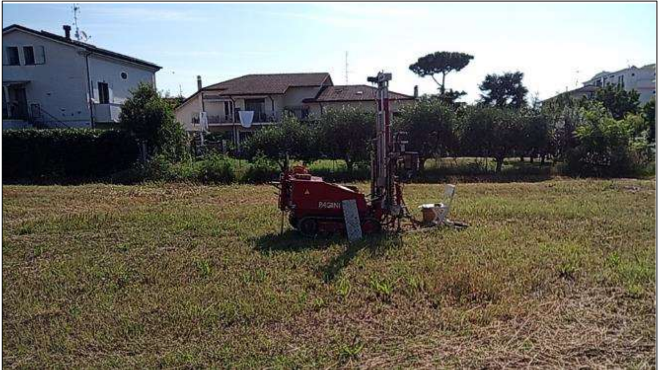
Figura 10 Penetrometro Pagani TG63/200 nel corso delle prove
